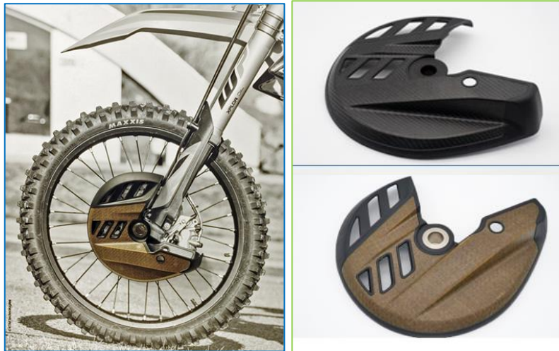
展示の亜麻製ディスクブレーキカバー 黒色は従来の CFRP 製 (KTM Technologies)
